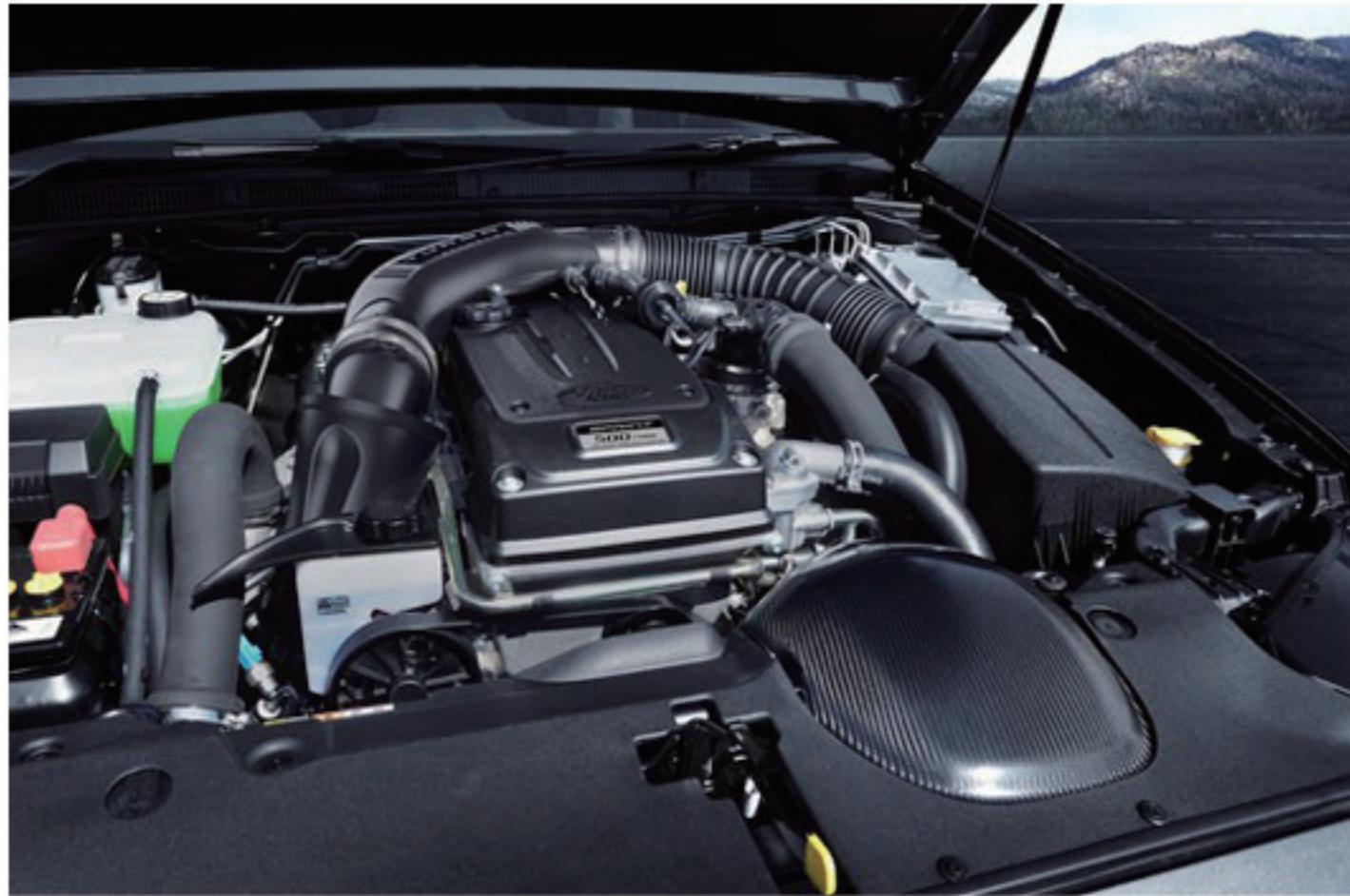
根据汽车新闻网站 Motorauthority 报道，澳大利亚福特公布了其 100% 碳纤维制造的进气系统，该进气系统将在福特最近发布的新高性能轿车 FalconXR6 Sprint 车型上应用。
